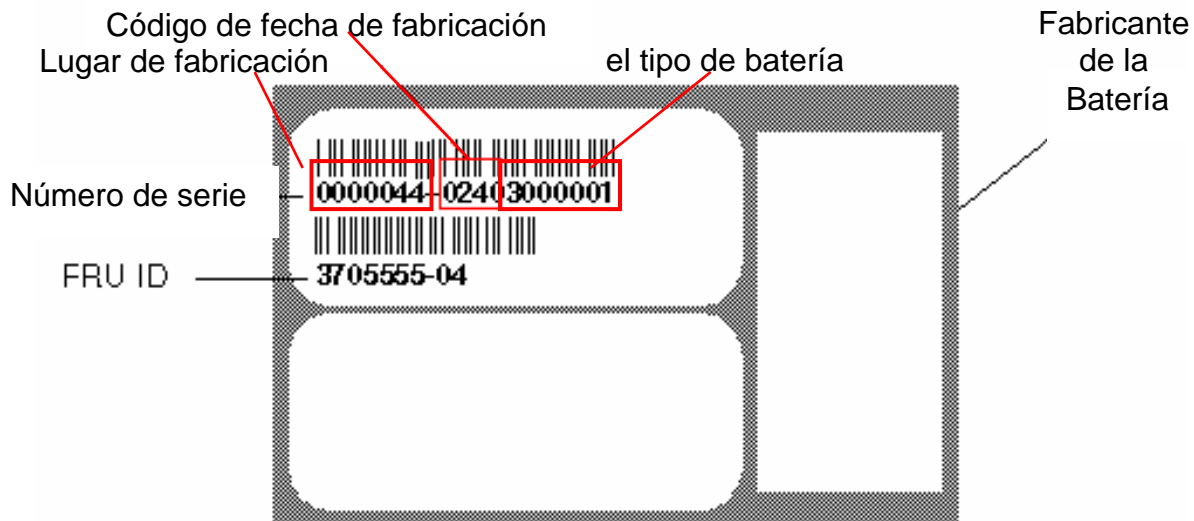
Fig.1 - En este ejemplo de una batería Sun StorEdge 3310 SCSI Array aparecen: un código de siete dígitos debajo del código de barras superior, que indica el lugar de fabricación, un guión (-) y luego un código de cuatro dígitos que indica la fecha de fabricación, seguido por un número de identificación serial de seis dígitos asignado por el fabricante. La fecha de fabricación de la batería está indicada por "0240", en donde "02" es el año y "40" la semana de la fabricación.
